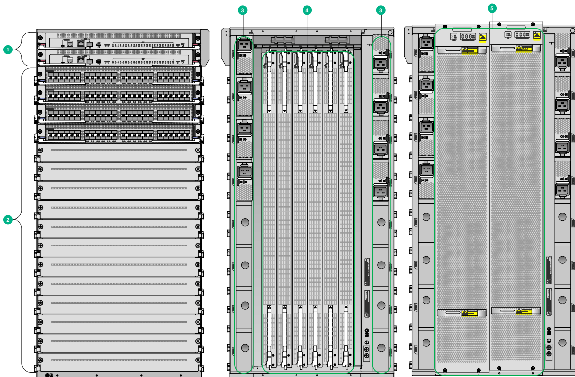
图1-3 S12600-16-G 交换机前、后面板示意图
